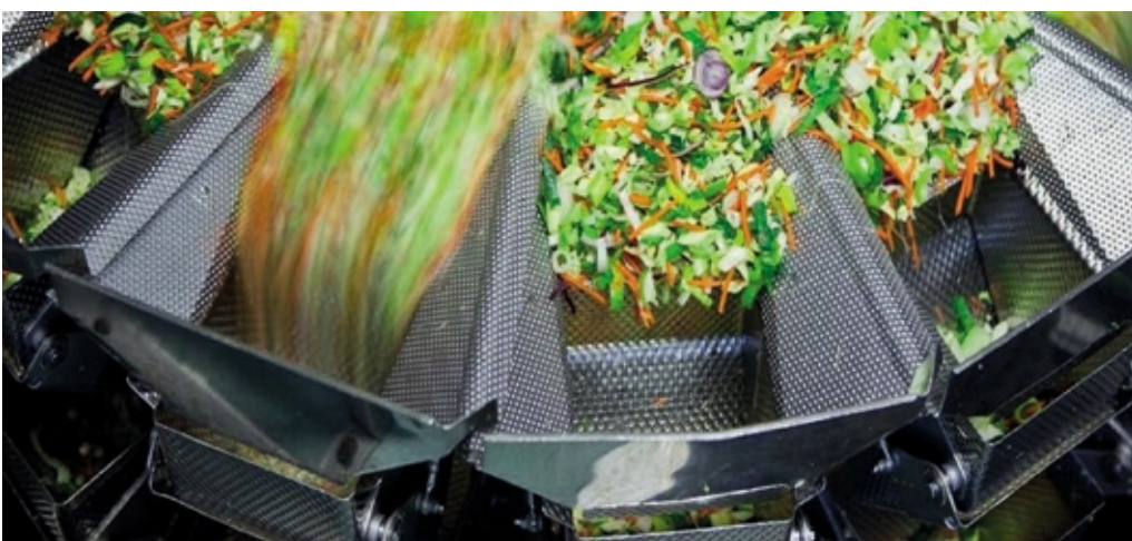
In alto: la stanza "Cielo Stellato" di uno yacht privato, le maniglie e scaffalature sono state realizzate con acciaio inox SuperMirror; sotto un forno commerciale realizzato con lamiere inox nella finitura Black Canvas. Qui a fianco una macchina imbustratrice per l'insalata realizzata con acciaio inox 15DP.
